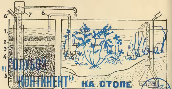
1. Гравий. 2. Мелкий песок. 3. Стекловата (или ватля). 4. Активированный уголь. 5. Камера фильтрованной воды. Обделается целлулоидным ситом или заполняется гравием. 6. Поддача воздуха. 7. Контейнер чистой воды. 8. П-образная трубка.
