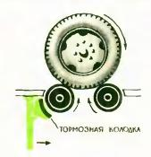
таки заметили, что автомобиль самостоятельно не сможет съехать с валков, отбирающих мощность с задних колес. Ребята предлагают своеобразный тормоз. Когда валки прижаты тормозной колодкой, машина съедет без пробуксовывания.
