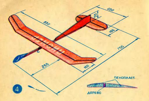
Корпус, крылья и стабилизатор вырежьте из пластин пенопласта. Конфигурацию крыльев не обязательно соблюдать точно, важно лишь не уменьшить их площадь и не нарушить симметричность каждой пары.
