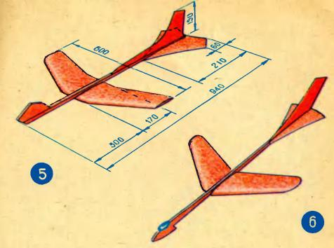
стабилизатора сверху нужно врезать тонкую деревянную реечку. Для этого примерно посредине крыла вырезается паз по ширине реечки, сама реечка смазывается клеем и вставляется в паз.
