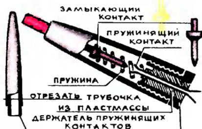
**ДРЕЛЬ С ЛИНЕЙКОЙ.** «Я занимаюсь в судомодельном кружке, — пишет А. Горбунов из Баку. — При изготовлении корпусов заготовки приходится сначала рассверливать, а затем долбить долотом. Чтобы не просверлить заготовку насквозь, на сверле делают отметку мелом. Это неудобно. Предлагаю к дрели прикрепить линейку и трубку, в которой свободно ходит стержень.
