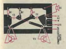
Монтажная плата звукового генератора.
