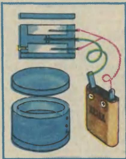
Работает датчик от батарейки для карманного фонарика. Верхний и нижний электроды подсоедините к положительному полюсу, а средний — к отрицательному. В цепь подключите реостат, а также вольтметр и микроамперметр.
