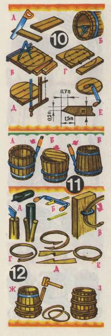
В бондарной посуде клепки сопрягаются друг с другом боковыми кромками. Чем точнее выполнена их фуговка, тем плотнее они прилегают друг к другу, тем надежнее и прочнее бондарная посуда. Кромки фугуют на фуганке (рис. 6A) или же в ладиле (рис. 6Б). Работу прекращают, как только из-под железки фуганка станет выходить непрерывная стружка.
