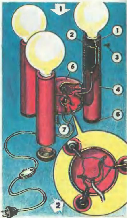
На рисунке: 1 — патрон («миньон»); 2 — канавка; 3 — стопор; 4 — трубка; 5 — заглушка; 6 — пустотелая шайба; 7 — крепежные шурупы.
