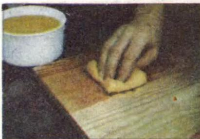
лака. А особого изыска добьетесь, если выбеленную поверхность покроете воском или парафином. Воск расплавляют, снимают с огня, смешивают со скрипидаром (воск — 60%, скрипидар — 40%). Вощение производят, когда состав остынет. Его наносят на древесину равномерным слоем, без пропусков, кистью с жесткой и короткой щетиной. Восковой слой выдерживают 24 часа при температуре 18... 20°C. Затем растирают суконкой до появления равномерного блеска.
