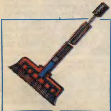
Патентное бюро. Он предлагает встроить в ручку швабры насос, подобный велосипедному, а в колодке просверлить отверстия, соединенные с его полостью. Теперь, при опускании швабры в ведро, вытягивая ручку насоса, забирают воду, а потом постепенно выдавливают ее на тряпку, намотанную на колодку швабры. И вода не растекается куда не следует, и большую поверхность удается смочить за один раз.
