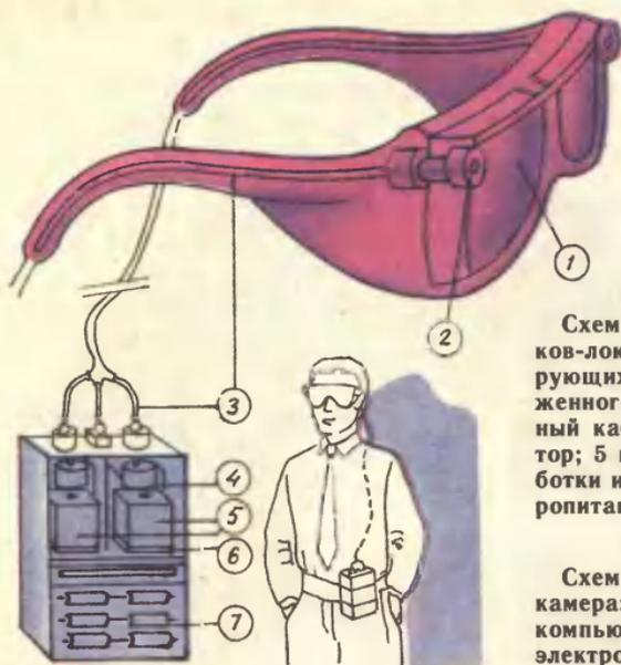
Схема, поясняющая устройство очко-локаторов: 1 — источник зондирующих импульсов; 2 — приемник отраженного излучения; 3 — соединительный кабель; 4 — звуковой сигнализатор; 5 и 6 — электронные блоки обработки информации; 7 — система электропитания.
