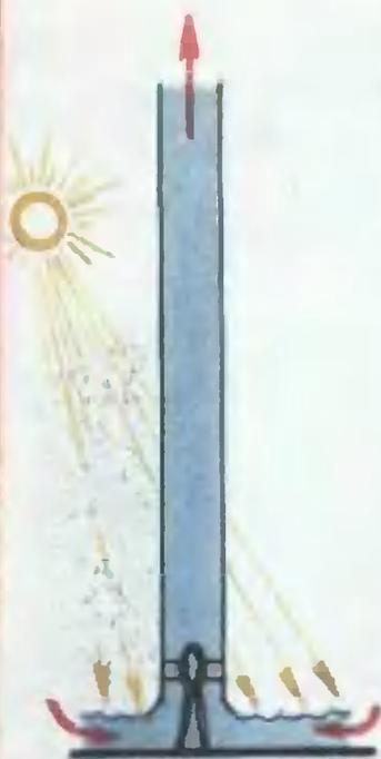
Схема станции, работающей по принципу «тяги вверх», когда теплый воздух, нагретый под пленкой, поднимается в верхние слои атмосферы.
