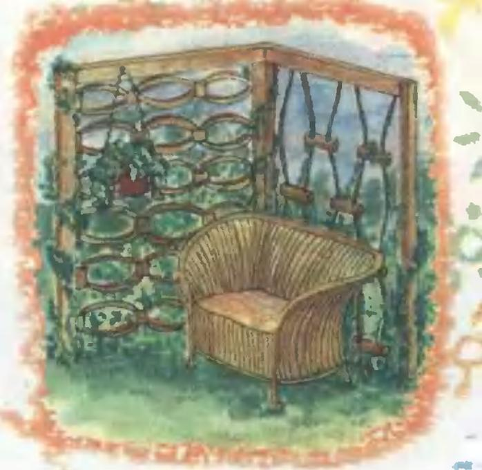
соб защиты уголка отдыха от яркого солнца. Это так называемые экраны — декоративные перегородки, служащие опорой для вьюнов, декоративного винограда. На участке наверняка найдутся обрезки досок и другой строительный материал. Деревянную раму 1500х1500 мм можно склотить из брусков 60х60 мм. На рисунке 2 слева показано, как заполнить деревянный квад-
