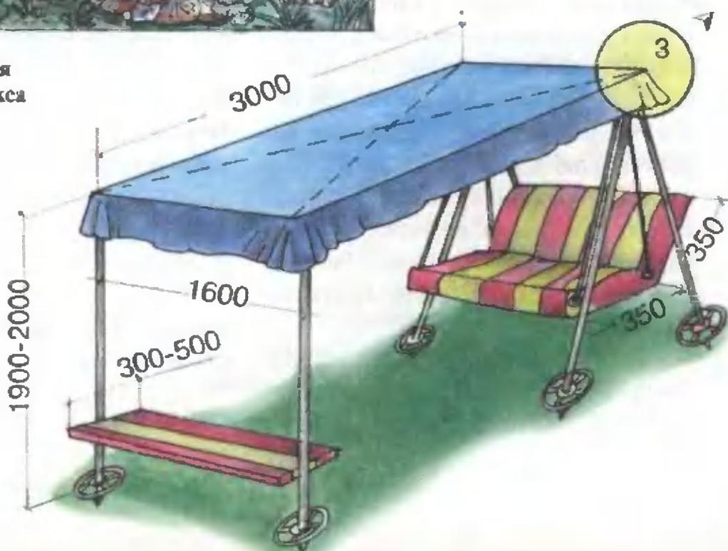
ветуем скрепить его по диагонали тонкими стальными тросами или проволокой диаметром 3 — 4 мм.
