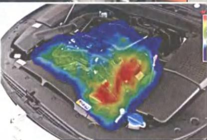
шать, но и рассмотреть источник любых подозрительных шумов в двигателях, приборных панелях, дверях и других деталях автомобилей, рассказывает издание IEEE Spectrum.
