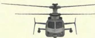
Sikorsky S-97 — это разведывательный вертолет американской компании Sikorsky Aircraft, построенный по соосной схеме с толкающим винтом в хвостовой части. Разработан на базе экспериментального вертолета X2 той же фирмы. Первый полет S-97 запланирован на 2015 год.
