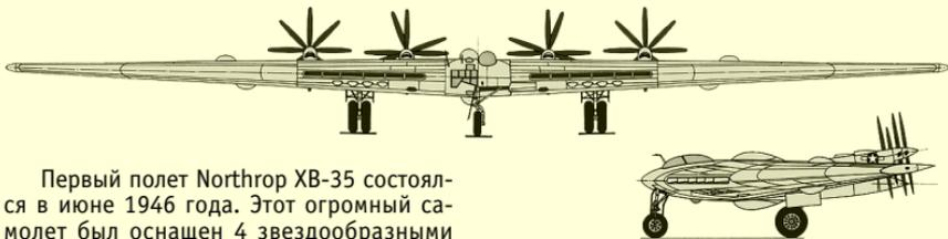
Первый полет Northrop XB-35 состоялся в июне 1946 года. Этот огромный самолет был оснащен 4 звездообразными двигателями воздушного охлаждения Pratt & Whitney — двумя типа R-4360-17 и двумя типа R-4360-21 мощностью по 3000 л. с. каждый.
