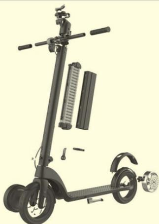
Turboant X7 Pro оснащен двигателем мощностью 350 Вт, который позволяет развивать скорость до 32 км/ч. Литий-ионный аккумулятор заряжается примерно за 6 часов.
