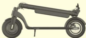
Дополнительные возможности: стоп-сигнал, передний фонарь (3 Вт), звонок, круиз-контроль, дисплей со считыванием скорости, индикатором режима и уровнем заряда батареи (полоски). Самокат имеет 3 скоростных режима.
