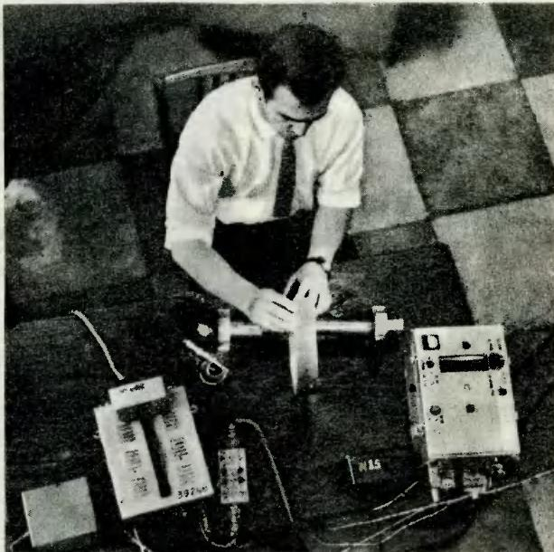
Где только не используют вибрацию! Она помогает выжимать сок, уплотняет бетон, ускоряет химические реакции. В Минском политехническом институте подыскивают ей еще одно применение. Здесь заставили вибрировать валки опытного прокатного стана, и металл стал гораздо податливее к обработке, чем обычно. На снимке один из моментов опыта.
