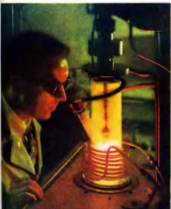
Высокая температура требуется и для выращивания в лабораторных условиях монокристалла полупроводника (фото внизу слева). Кристалл выращивается не на пустом месте, тут нужна затравка — основа, в качестве которой используется другой кристалл. Вещество, находящееся в кристаллическом состоянии, таит в себе немало тайн. Ученые многих стран занимаются их разгадкой. На правом нижнем снимке — искусственный гранат.
