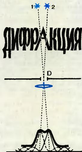
тенсивность дифракционных картин от двух точек в предельном случае — когда они еще различимы. Сплошной линией изображена суммарная интенсивность.
