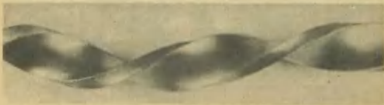
Фото 1. Заготовка из иттриевого чугуна после испытаний.
