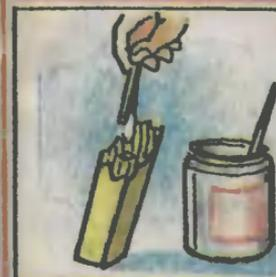
Деревянный шкант диаметром 8 мм намажем столлярным клеем...
