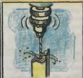
Отмеченные на обоих разломах точки просверлим на глубину 20 мм.
