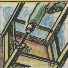
Дрель со сверлом 6,5—7 мм держим так, чтобы отверстие получилось строго вертикальным.
