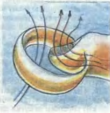
Кольцевая насадка-эжектор, установленная на концах лопастей ветродвигателя Андро увеличивает его эффективность в 3 - 5 раз.
