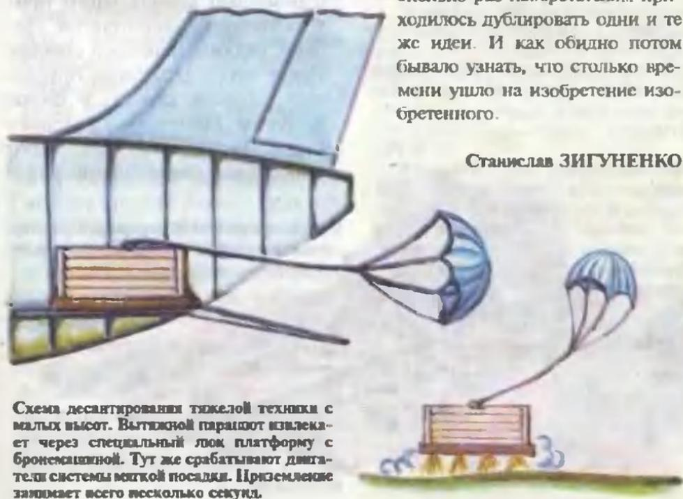
Схема десантирования тяжелой техники с малых высот. Вытяжной парашют извлекает через специальный люк платформу с бронемашинной. Тут же срабатывают двигатели системы мягкой посадки. Приземление занимает всего несколько секунд.
