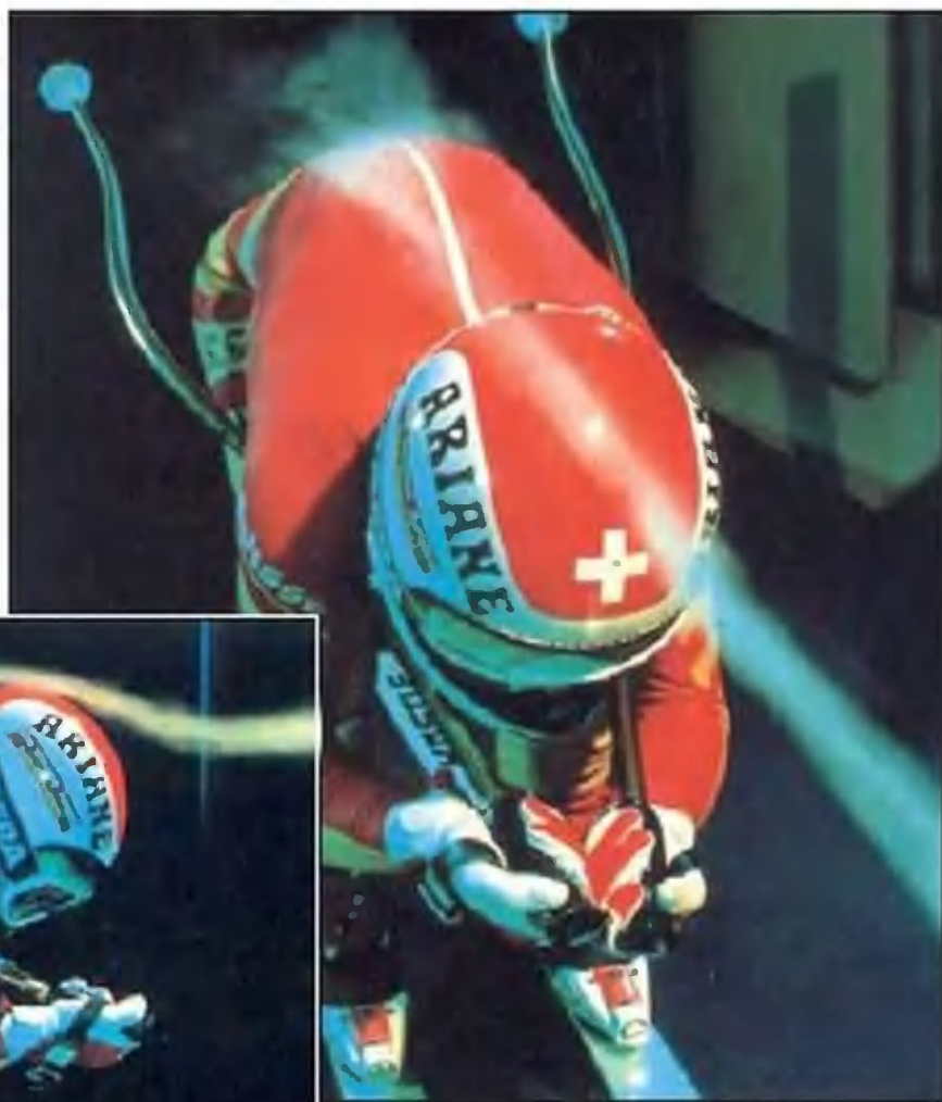
Современный обтекаемый костюм горнолыжника проверяется в аэродинамической трубе.
