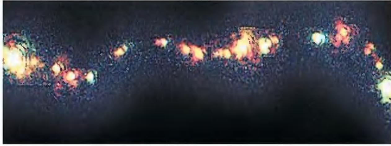
**ЭТО ВОВСЕ НЕ СВЕТ СВЕТЛЯКА В НОЧИ**, а фотоизображение свечения самого миниатюрного электролюминесцентного источника в мире, который был создан сотрудниками Технологического института штата Джорджия, США. Свечение достигнуто за счет выделения отдельных фотонов из молекул оксида серебра. Полагают, что столь миниатюрные фонарики можно будет использовать для нанолитографии, при производстве особо компактных микрозлектронных схем, для создания оптических устройств особой компактности.
