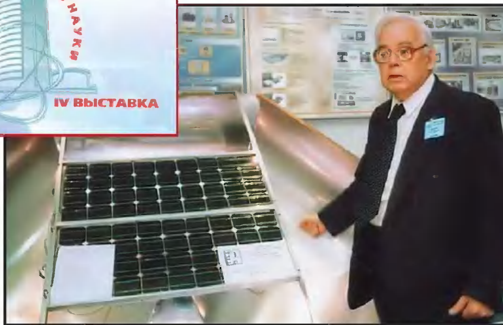
Н.Молоснов демонстрирует один из вариантов солнечной батареи с зеркалом-концентратором.
