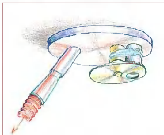
Присоска с прерывателем воздушного потока — вращающимся диском с отверстием. При достаточно больших его оборотах присоска может двигаться, не отрываясь от потолка.
