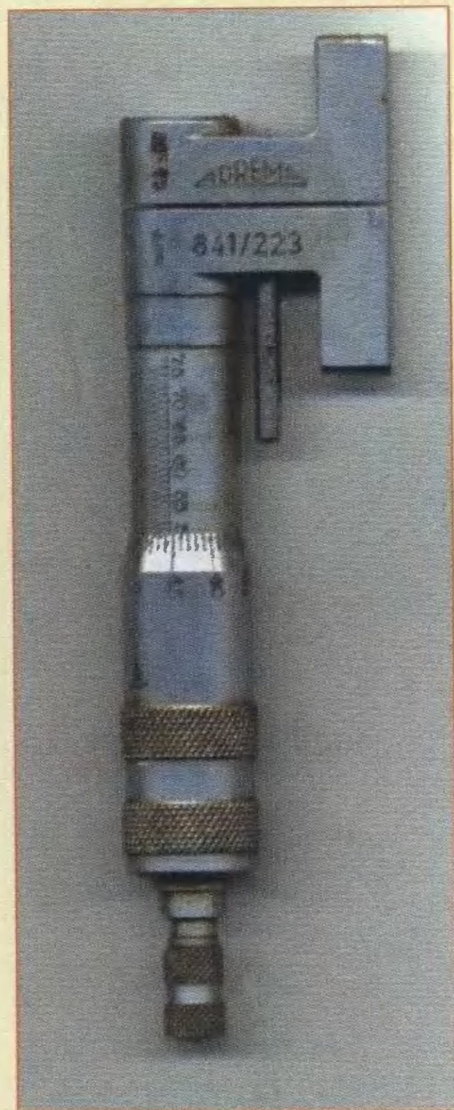
Штихмас — микрометр для измерения внутренних размеров.
