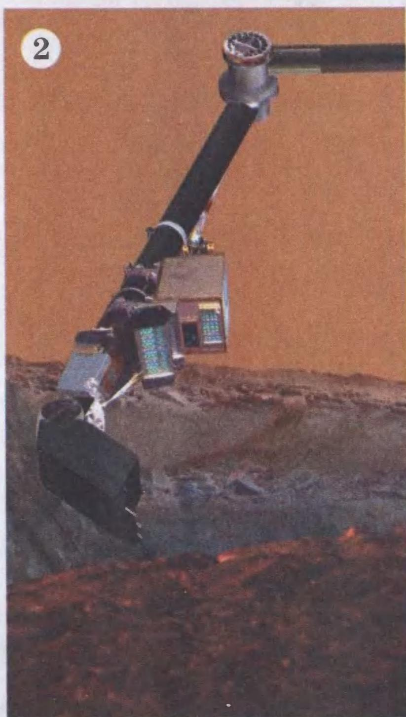
1. Отсюда робот взял пробу грунта.
