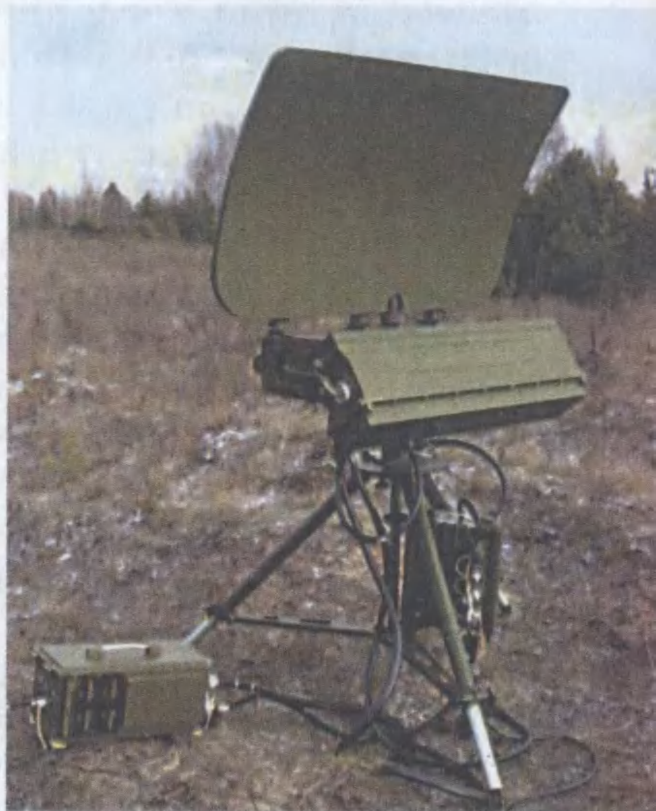
Радиолокационная станция «Аистенок».
