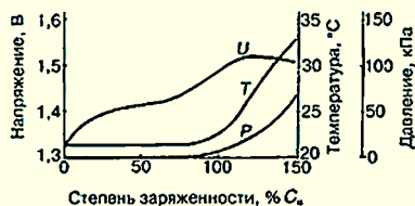
Рис. 10. Изменение параметров Ni-Cd-аккумулятора при заряде.
