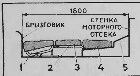
Рис. 1. Полная раскладка сидений: 1 — переднее сиденье, «шагнувшее» вперед и вставшее на упоры; 2 — спинка переднего сиденья, вставленная в его горизонтальные гнезда; 3 — спинка заднего сиденья; 4 — заднее сиденье; 5 — пол багажника за задним сиденьем.
