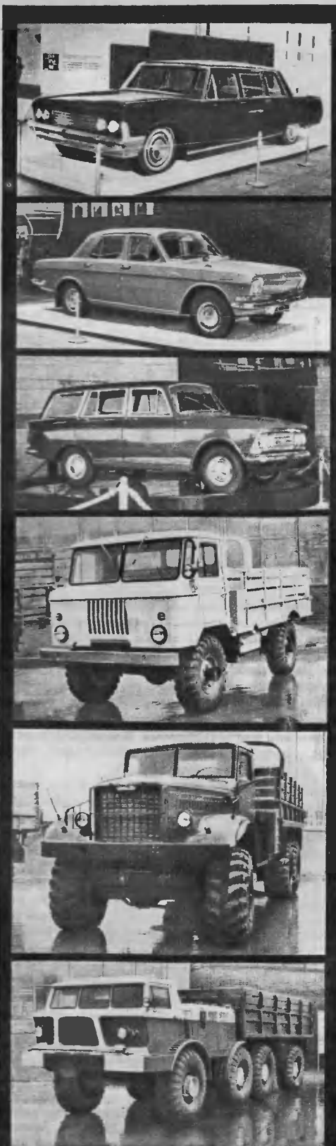
На фото (сверху вниз): ЗИЛ-114 — автомобиль экстра-класса; ГАЗ-24 — новая «Волга»; «Москвич-426 универсал» (повышенная грузоподъемность, усиленные шины); ГАЗ-66 — двухтонный грузовик повышенной проходимости; ГАЗ-255Б — автомобиль большой грузоподъемности, предназначенный для работы на дорогах всех категорий и бездорожье; ГАЗ-135Л4 — 9-тонный грузовик, может работать в любых дорожных условиях.
