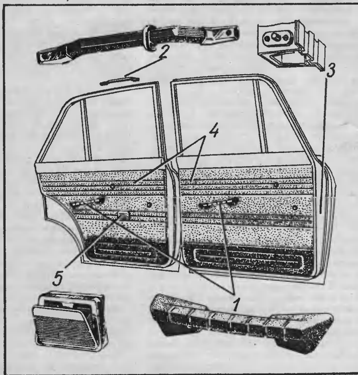
Рис. 5. Внутренняя отделка: 1 — мягкая подушка; 2 — панель с декоративными вставками; 3 — панель с декоративными вставками; 4 — панель с декоративными вставками; 5 — пепельница
