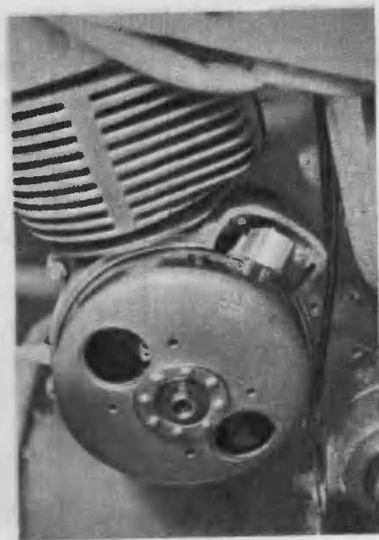
Рис. 4. Генератор, установленный на двигателе.
