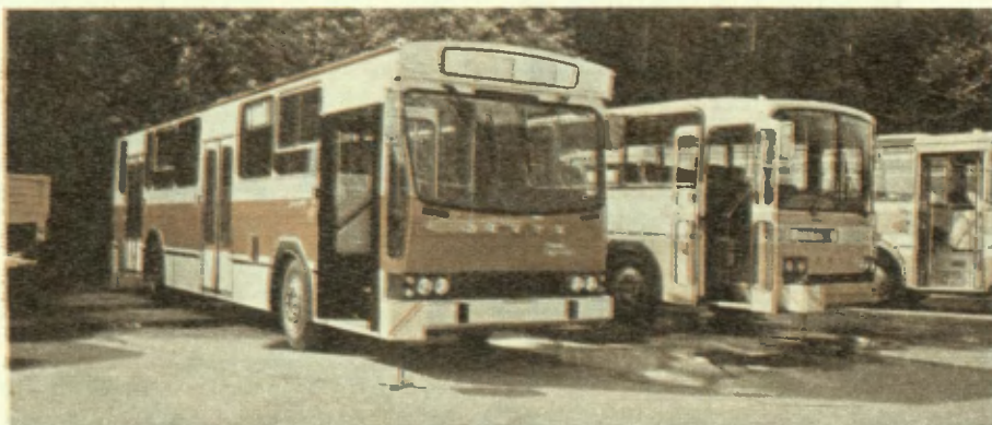
Два автобуса марки «Ельч-Берлие» — городской и туристский (оба имеют дизельный двигатель — 185 л. с., скорость — 103 км/ч).
