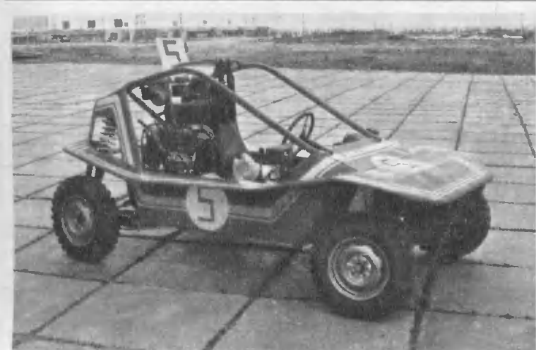
3. Багги, построенный на КамАЗе: компоновка — двигатель в пределах базы; двигатель ВАЗ; подвеска всех колес — независимая; база — 2100 мм; колея — 1350/1500 мм; масса — 520 кг.
