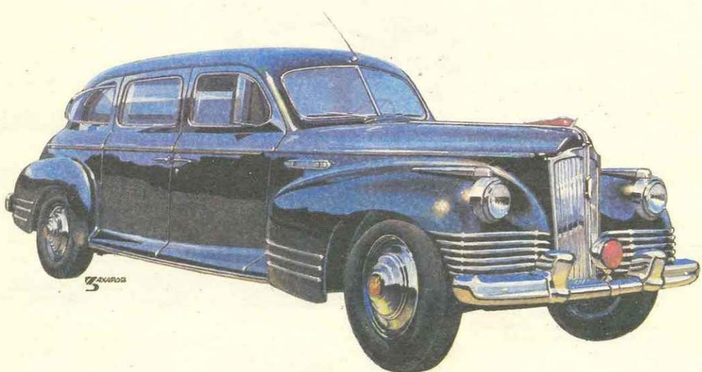
Годы выпуска — 1946—1958; количество мест — 7 [6]; двигатель: количество цилиндров — 8, рабочий объем — 6005 см<sup>3</sup>, мощность — 140 л. с./103 кВт [162 л. с./190 кВт] при 3600 об/мин; сцепление — однодисковое; число передач — 3; размер шин — 7,50—16 [7,50—17]; длина — 6000 мм; ширина — 1960 мм; высота — 1730 мм; база — 3760 мм; масса в снаряженном состоянии — 2757 [7300] кг; наибольшая скорость — 140[100] км/ч; средний эксплуатационный расход топлива — 27 [30] л/100 км.
