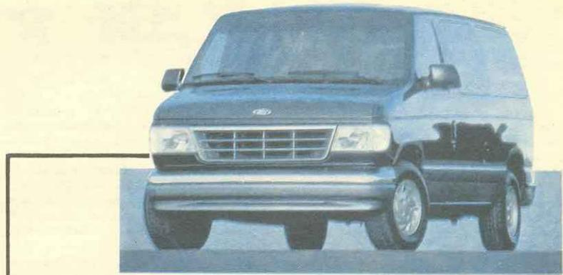
Фургон «Форд-Эконолайн», унифицированный с микроавтобусом. В таком фургоне возможно применение как распашных, так и сдвижных боковых дверей. В пассажирской модификации часть сидений или все могут быть легко демонтированы владельцем для перевозки груза. Колесная база — 3150 мм. Полная масса — 2451 кг. Двигатель: 6 цилиндров, 4917 см<sup>3</sup>, 145 л. с./107 кВт при 3400 об/мин. Коробка передач — 5 ступенчатая. Колесная формула — 4×2.
