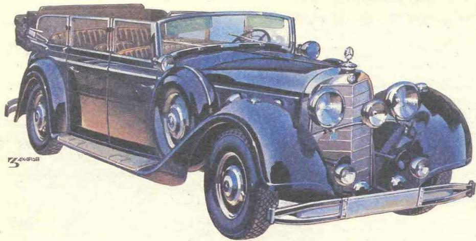
Год постройки — 1939; количество мест — 7; двигатель: число цилиндров — 8, рабочий объем — 7655 см<sup>3</sup>, мощность — 230 л. с./169 кВт [400 л. с./294 кВт] при 3200 [3600] об/мин; сцепление — двухдисковое; число передач — 5; размер шин — 8,25—17 [8,25—19]; длина — 6000 мм; ширина — 2070 мм; высота — 1800 мм; база — 3880 мм; масса в снаряженном состоянии — 3400 [4780] кг; наибольшая скорость — 170[180] км/ч; средний эксплуатационный расход топлива — 30 [38] л/100 км.
