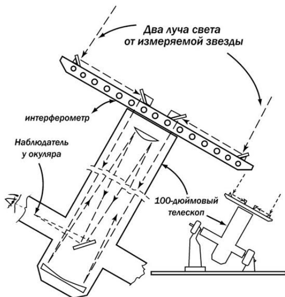
Рис. 72. Схема установки, поясняющей устройство прибора интерферометра для измерения угловых диаметров звезд (подробности в тексте)
