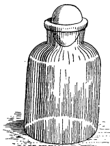
Рис. 35. Яйцо, вталкиваемое в бутылку атмосферным давлением.
