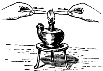
Рис. 53. Вытягивание стеклянной трубки.
