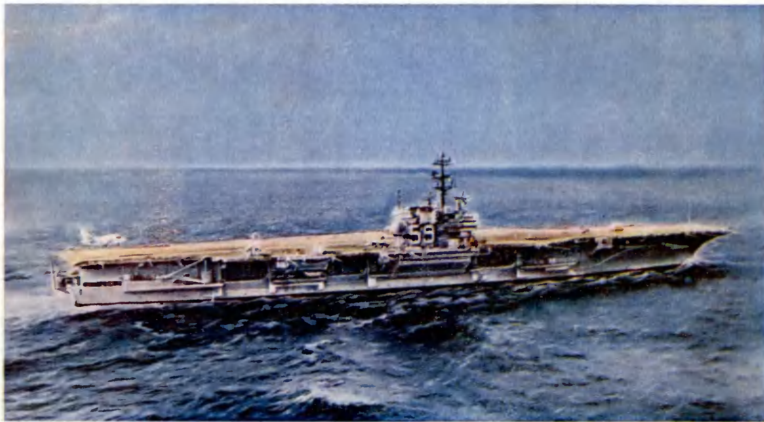
* АМЕРИКАНСКИЙ МНОГОЦЕЛЕВОЙ АВИАНОСЕЦ CV59 «ФОРРЕСТОЛ», оснащенный РЛС AN SPS-10. Водонизмещение стандартное 59 650 т, полное 78 000 т; длина 316,7 м, ширина 38,5 м, ширина полетной палубы 76,8 м, осадка 11,3 м; мощность энергетической установки 260 000 л. с., скорость хода 33 уз; вооружение: 85 самолетов система ЗУРО «Си Спарроу» (две пусковые установки) Экипаж 4940 человек, из них 2150 человек летно-технического состава
