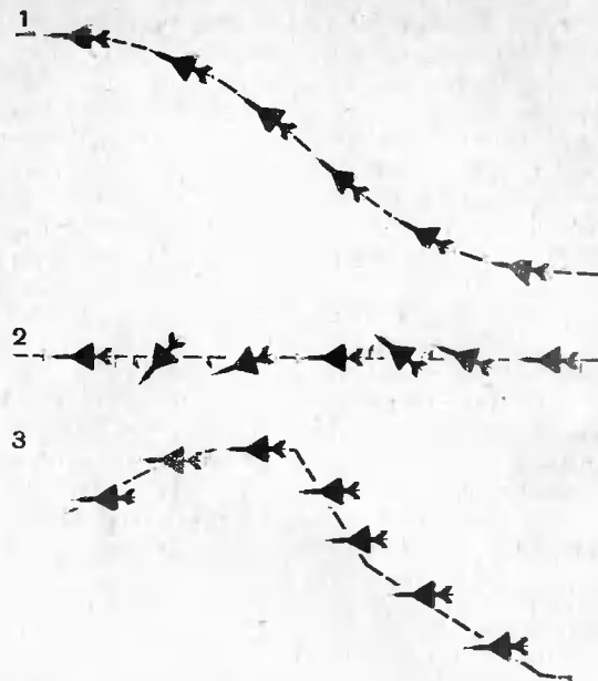
Рис. 2. Маневры самолета YF-16CCV в горизонтальной плоскости: 1 — плоские развороты (без крена); 2 — боковое ориентирование продольной оси самолета при полете по прямой; 3 — плоско-параллельные боковые перемещения
