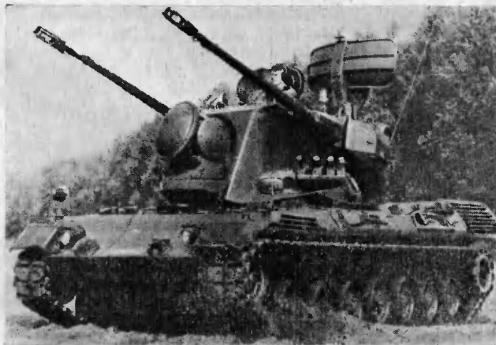
Рис. 1. 35-мм спаренная ЗСУ «Гепард» (ФРГ)
