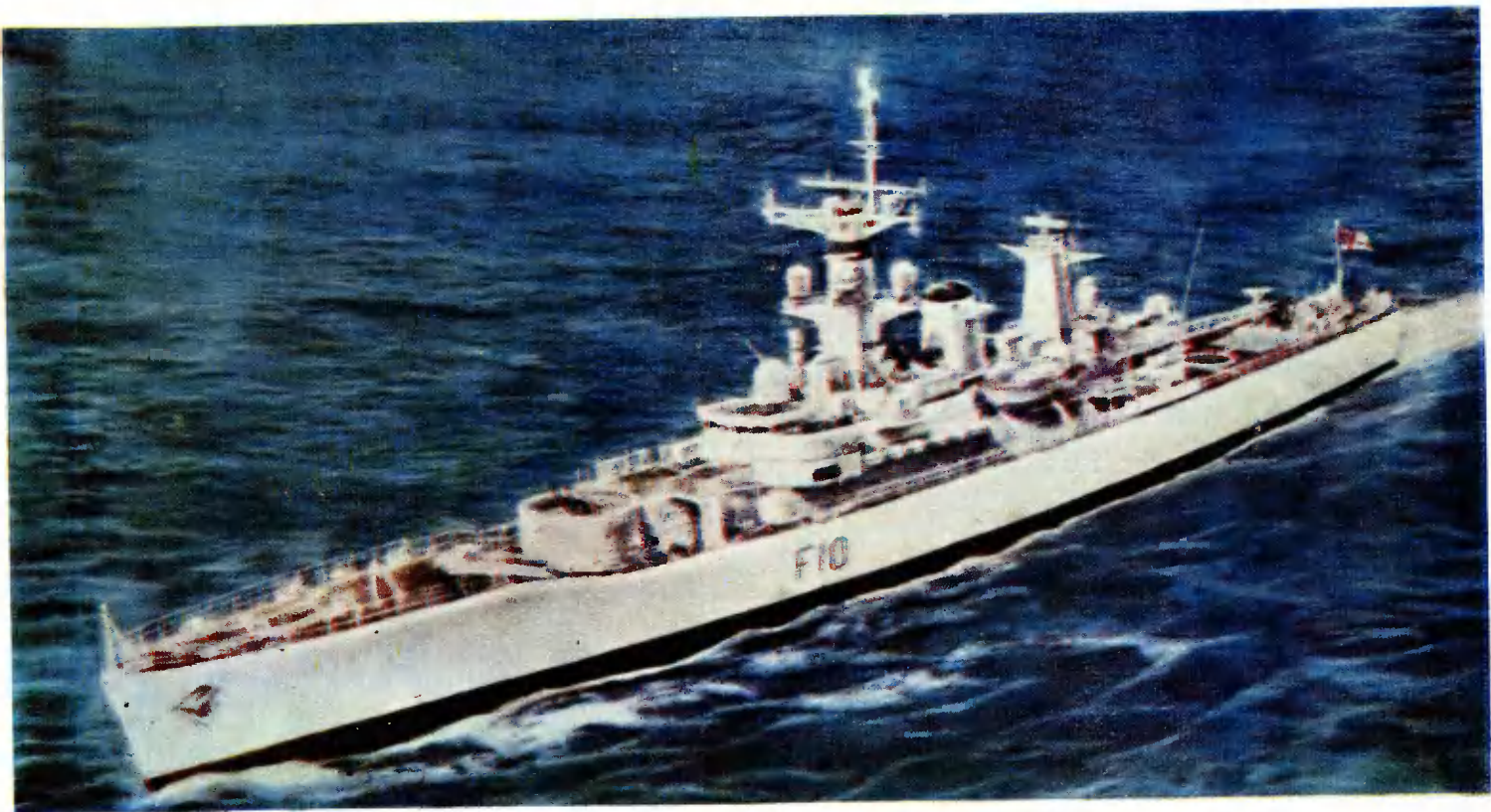
* АНГЛИЙСКИЙ ФРЕГАТ 110 «ОРОРА» (типа «Линдер»), оснащенный станцией спутниковой связи «Сиот»1. Основные тактико-технические данные корабля: водоизмещение стандартное 2450 т, полное 2860 т; длина 113,4 м, ширина 12,5 м, осадка 5,5 м; мощность энергетической установки 30 000 л. с.; скорость хода 30 уз; вооружение — системы ЗУРО «Си Кэт» и ПЛУРО «Икара», два 40-мм зенитных автомата, бомбомет «Лимбо», противолодочный вертолет. Экипаж 251 человек
