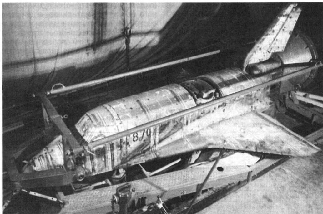
*Экспериментальный аппарат "Бор-5" для испытаний аэродинамических характеристик КК "Буран".*
