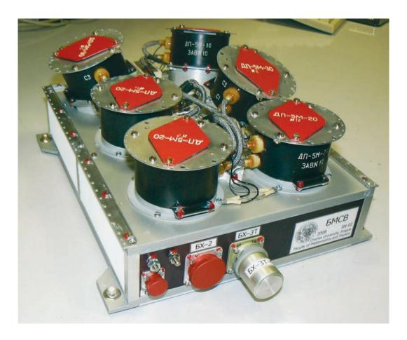
второй группы ("отвернутые") предназначены для быстрого измерения интенсивности потока ионов солнечного ветра и определения направления его вектора. Оси датчиков этой группы были отклонены от главной оси прибора на 20° и друг от друга на 120°.
