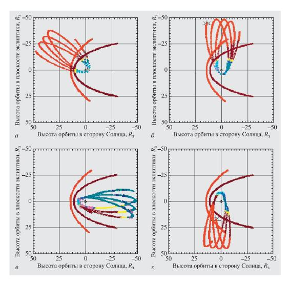
Диаграммы вариаций орбиты космической обсерватории "Спектр-Р": а) август 2011 г., б) октябрь 2011 г., в) январь 2012 г., г) апрель 2012 г. Красным цветом отмечены участки орбиты, находящиеся в солнечном ветре, коричневая параболическая линия — среднее положение магнитопаузы, красная параболическая линия — околоземной ударной волны.
