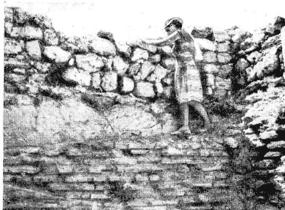
Рис. 9. Отбор образцов из кирпичной кладки в рыбозасолочной цистерне (Херсонес)
