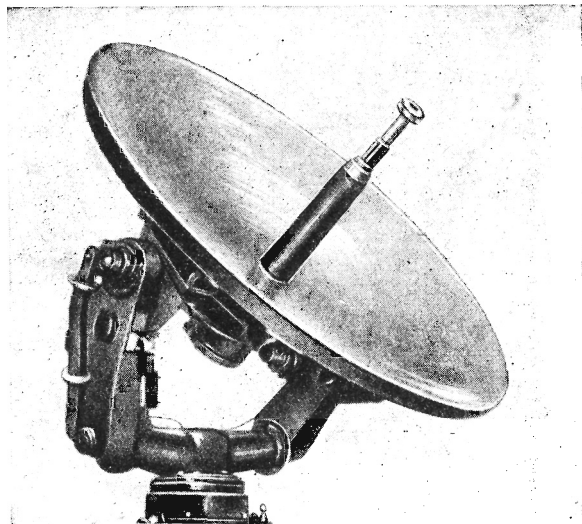
Антенна метеорологического радиолокатора, предназначенного для измерения ветра в верхнем слое атмосферы
