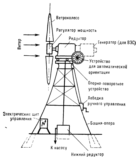
Схема преобразования энергии ветра. Колесо, вращаясь под действием ветрового потока, приводит в действие через редуктор любую рабочую машину, в том числе генератор или насос
