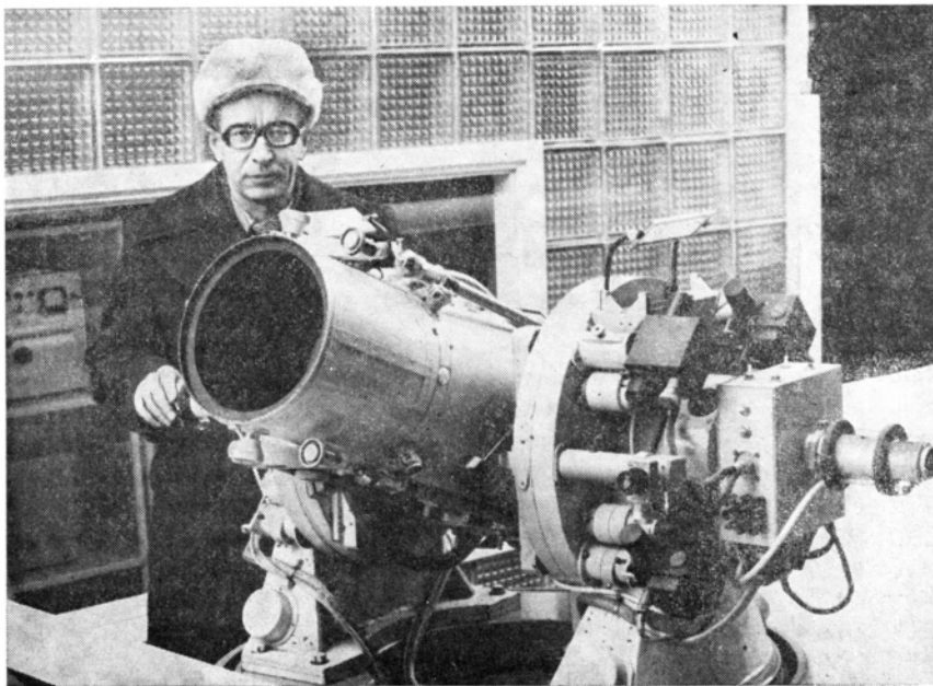
Пулковский фотографический вертикальный круг с фотоэлектрическим устройством для отсчета круга. У инструмента Б. К. Багильдинский Фото А. Сухоноса
