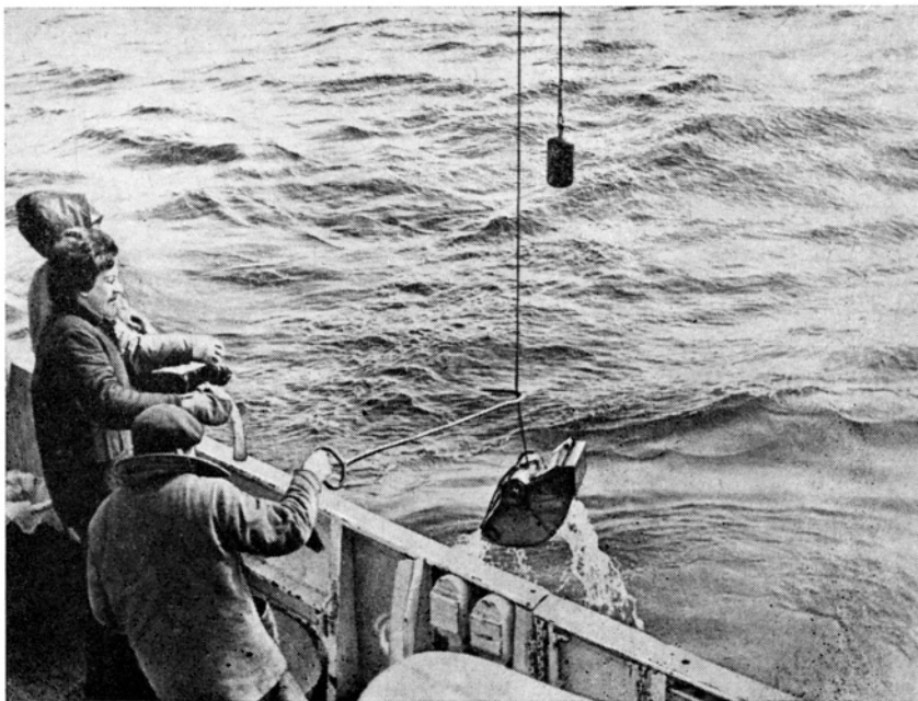
Подъем дночерпателя с пробой донных отложений
