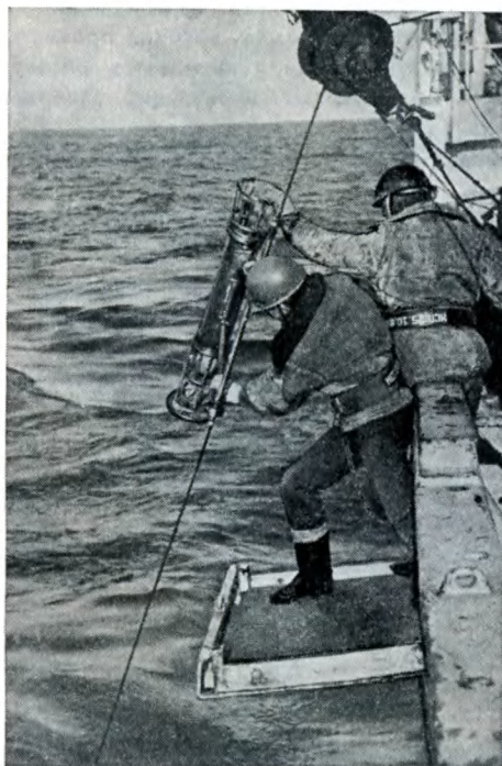
Наблюдения течений проводятся с помощью автономных цифровых измерителей течения (АЦИТ), которые устанавливаются на буйковых станциях. На снимке: прибор АЦИТ опускается за борт
