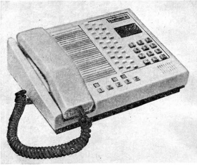
Телефонное устройство «Злетап-2», способное запоминать 30 запрограммированных номеров
