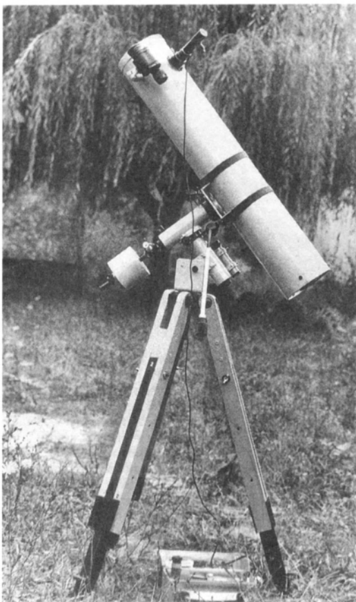
110-миллиметровый рефлектор системы Ньютона ( F=825 мм)
