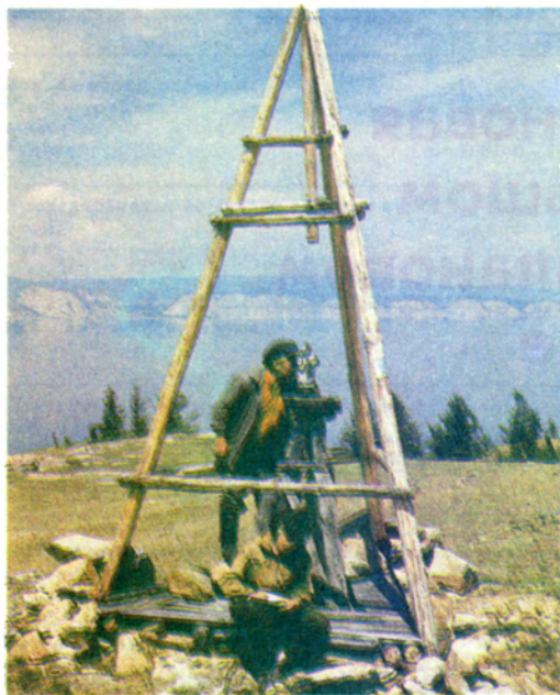
Геодезисты ведут линейные измерения вдоль берега Байкала
