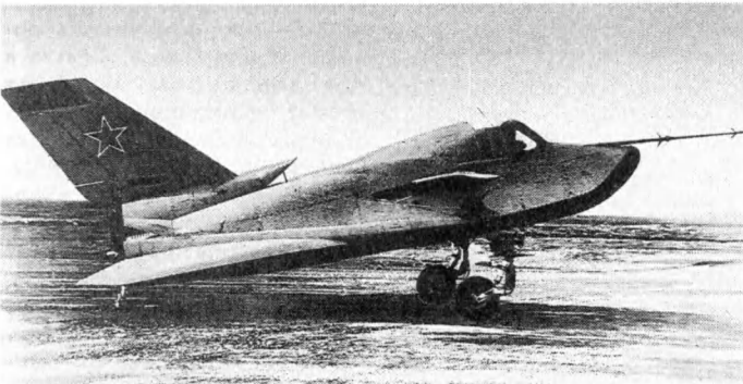
Пилотируемый экспериментальный самолет (полноразмерный аналог орбитального самолета «Спираль»). На нем в 70-х годах были совершены испытательные полеты в атмосфере
