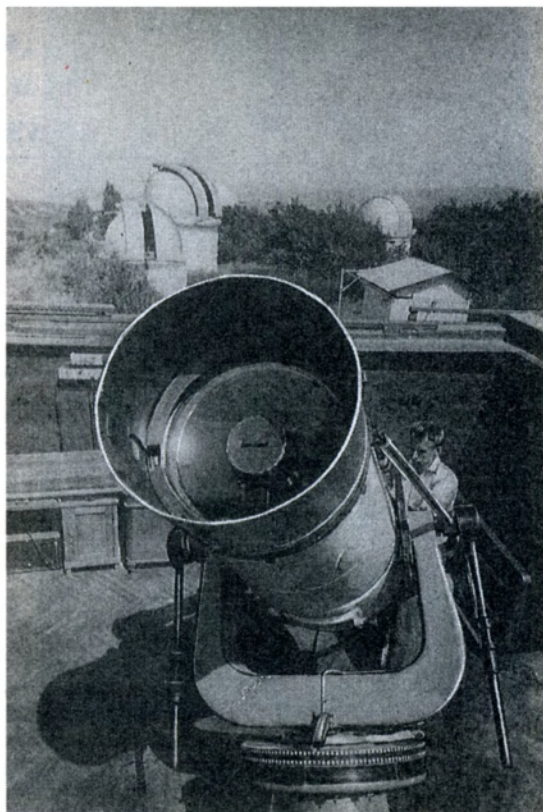
500-миллиметровый фотографический телескоп системы Максутова, установленный в Астрофизическом институте имени В. Г. Фесенкова АН КазССР (Алма-Ата)
