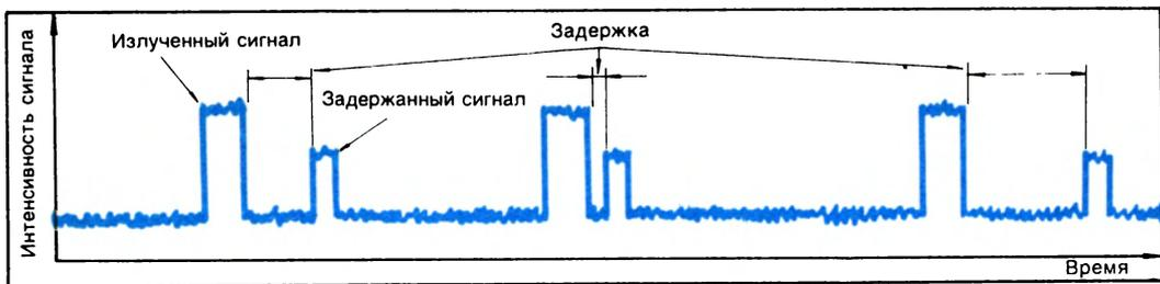
Так выглядит запись задержек сигналов. Импульсы большой амплитуды — излученный сигнал, низкой — принятый (радиоэхо). Временной промежуток между сигналом и эхом (задержка) все время меняется
